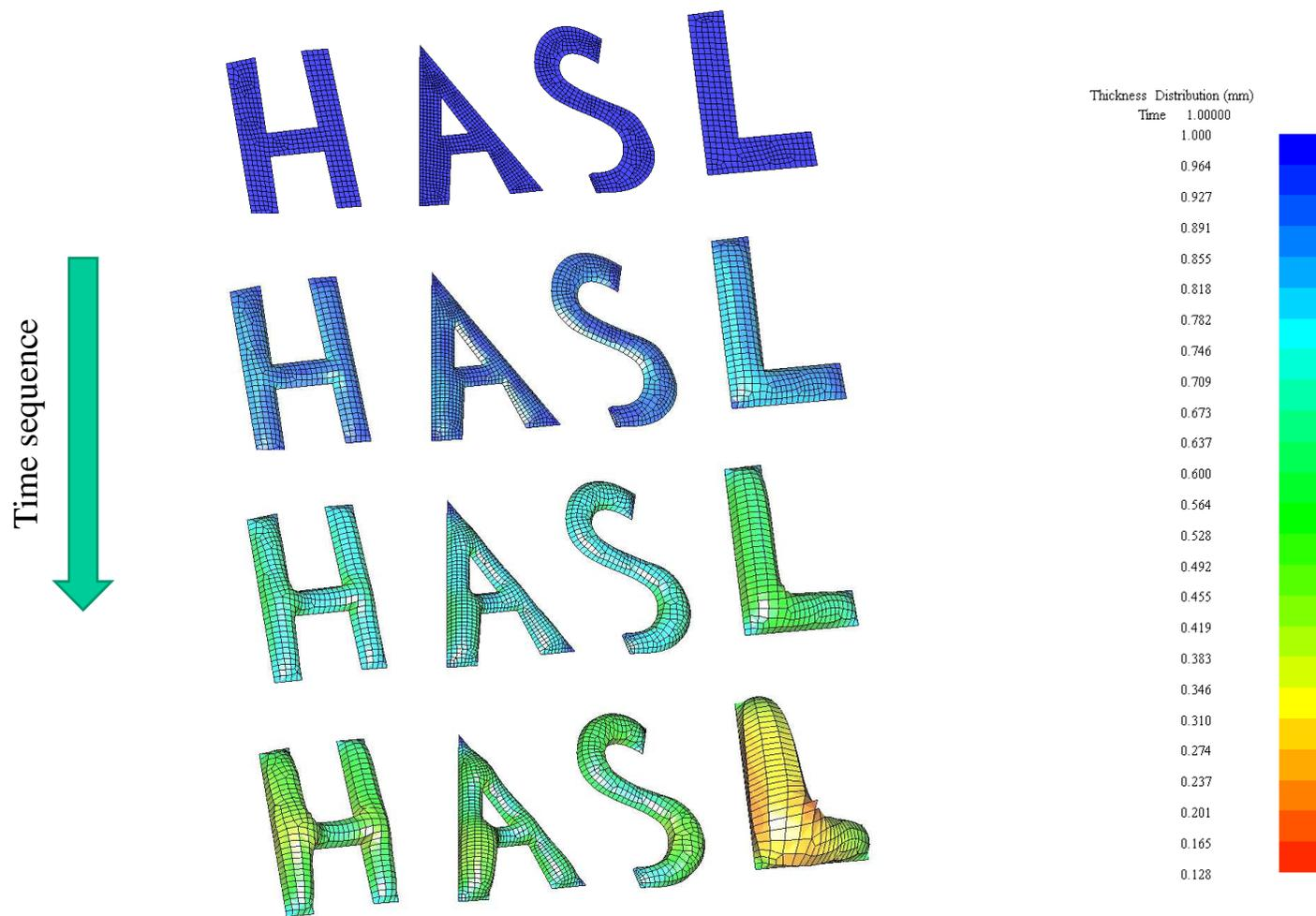
図4 フィルム形状と肉厚分布の時間変化予測結果
